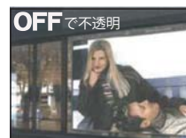
電圧を変化させることにより、透明度を自由に変えることができます。
